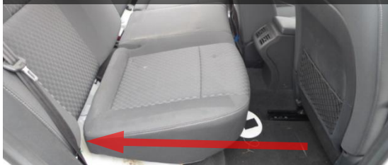
뒷자석 탈거 후 배선용 철사 삽입
