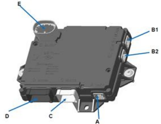
« A 커넥터 : CAN Input , B1 커넥터 : CAN Output , E 커넥터 : 모듈 전원공급 , B2/C/D 커넥터 옵션 커넥터(미사용)
