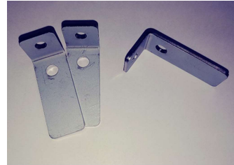
품명 : 마운팅 브라켓 수량 : 8EA 장착 위치: 사이드 하부 패널 사이드스텝 및 바에 부착
