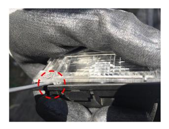
□ 1.8mm 플라스틱 (-)드라이버를 이용하여 표시 부위 커버를 개봉 후 좌/우 T10-B(무극성) 을 설치 한 후 작업을 마무리 한다.
