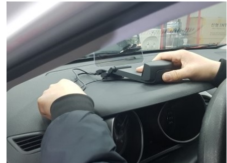
6. 전원 배선을 본체에 연결하여 전원을 ON 시켜 주세요.
