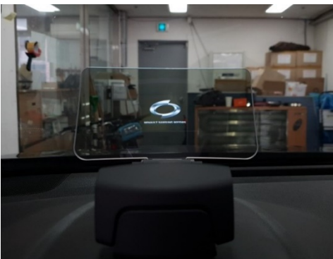
6. 운전석에서 HUD의 화면이 시야 정 중앙에 보이는 것을 확인 후 장착 지그를 사용해 실리콘 패드를 부착해 주세요.
