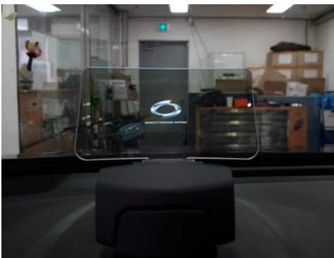
7. 운전석에서 HUD의 화면이 시야 정 중앙에 보이는 것을 확인 후 장착 지그를 사용해 실리콘 패드를 부착해 주세요.
