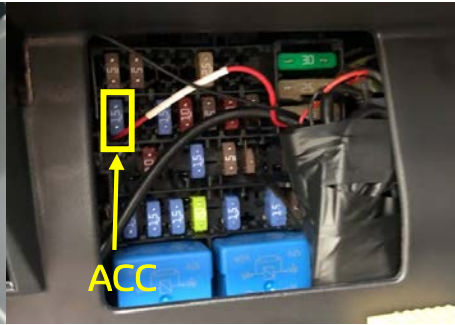
3. 운전석 사이드 커버와 퓨즈박스 커버를 분리해 퓨즈박스까지 전원선을 빼 주세요. 전원배선 중 적색선은 ACC에 검정색선은 GND(접지)에 연결해 주시면 됩니다.
