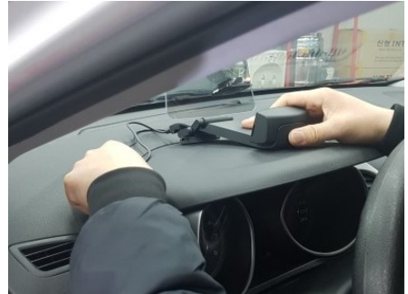
5. 전원 배선을 본체에 연결하여 전원을 ON 시켜 주세요.
